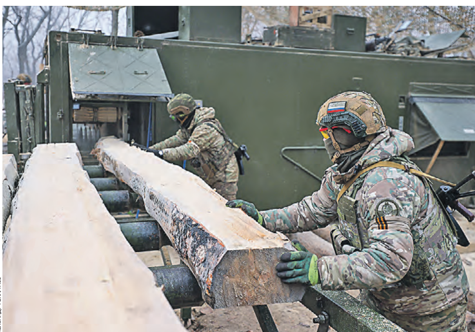
12 января. Военнослужащие инженерно-дорожного мостостроительного батальона отдельной инженерной бригады группировки «Запад» ВС РФ изготавливают деревянные понтоны в зоне СВО на территории Луганской Народной Республики. Такие деревянные понтоны необходимы военнослужащим для наведения мостовой переправы через водоемы
