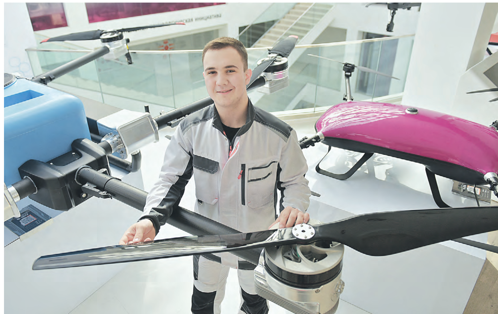
2 апреля. Инженер-механик Никита Остряков показывает модель дрона S-120, предназначенного для перевозки грузов до 50 килограммов. К нему можно прикрепить дополнительные винты, чтобы увеличить грузоподъемность до 200 килограммов. Фото: Наталья Феоктистова
