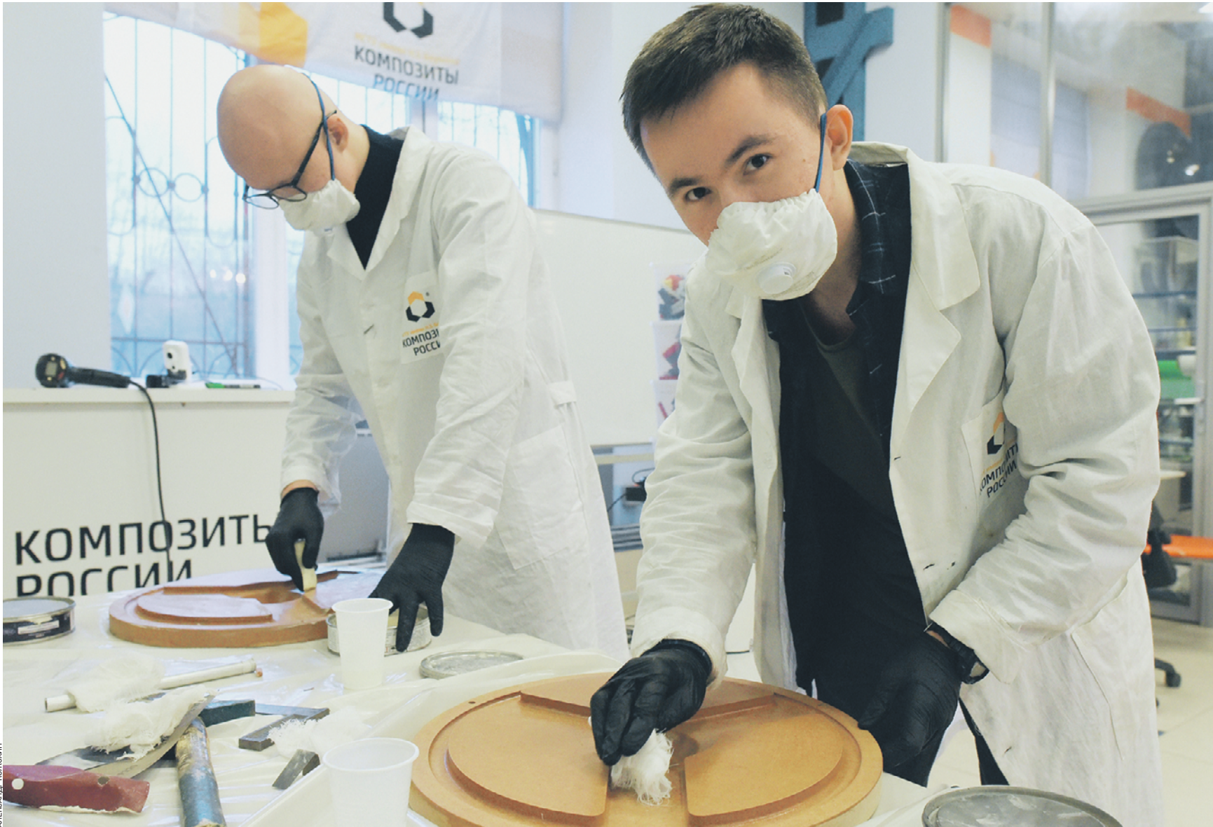
Вчера 15:41 Финальный этап чемпионата «Молодые профессионалы» в МГУ им. Н. Э. Баумана. Константин Новиков (справа) и Федор Иващенко готовят форму для изготовления велосипедного колеса из углеволокна
