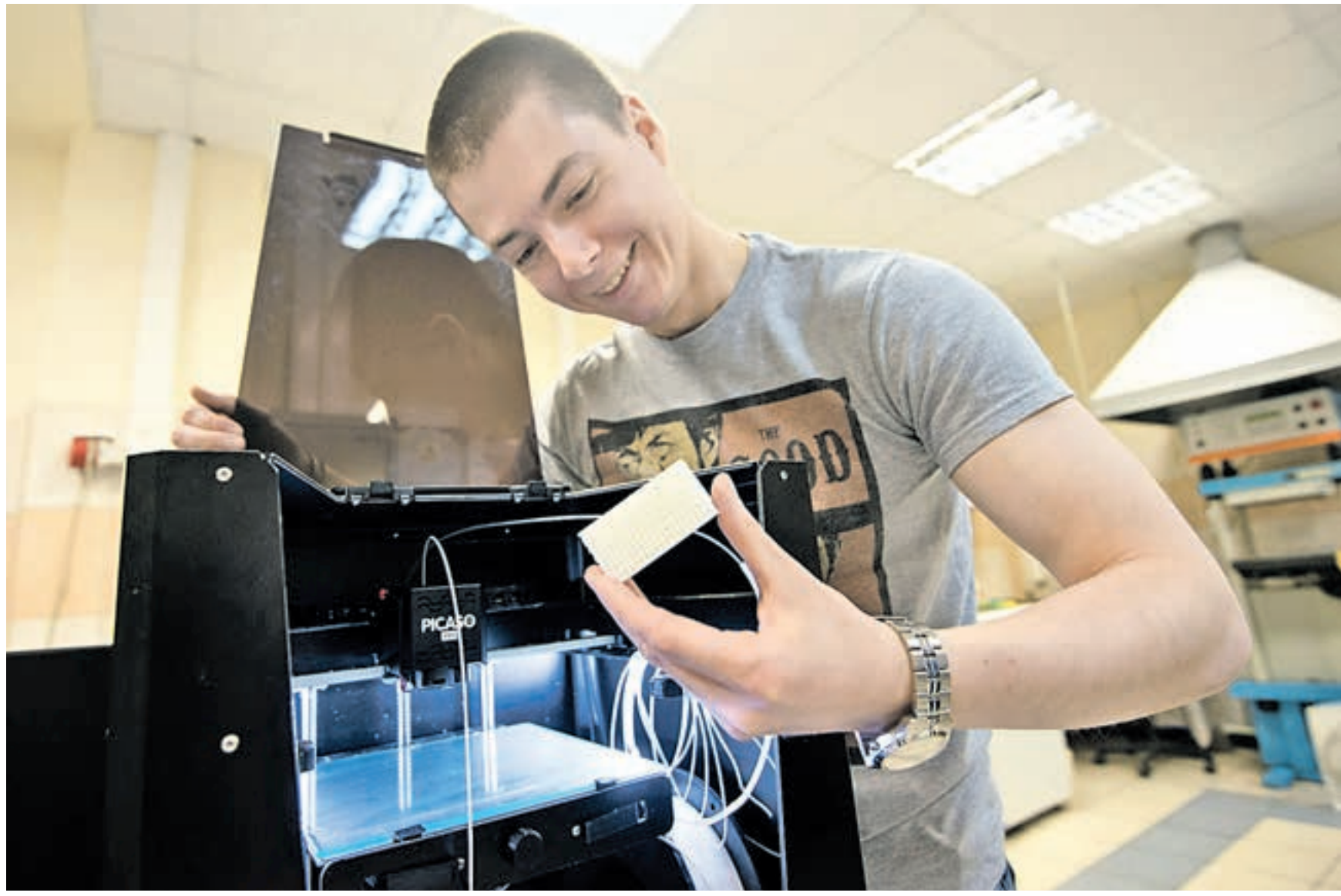
17 февраля 10:40 Научный сотрудник Центра композиционных материалов Федор Сенатов распечатал на 3D-принтере полимерный имплант с памятью формы, предназначенный для исправления дефектов костной ткани
