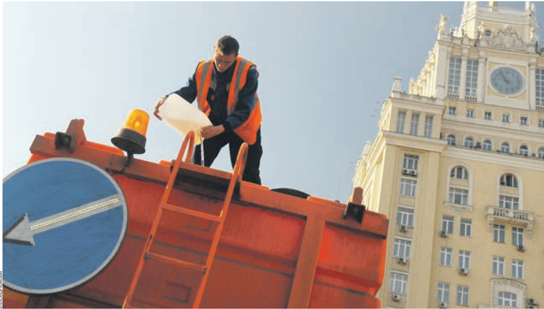
Вчера 10:56 Сотрудник ГБУ «Автомобильные дороги» Александр Римский заливает концентрированное моющее средство в цистерну своего автомобиля. Пропорции моющей смеси — один литр жидкости на тонну воды
