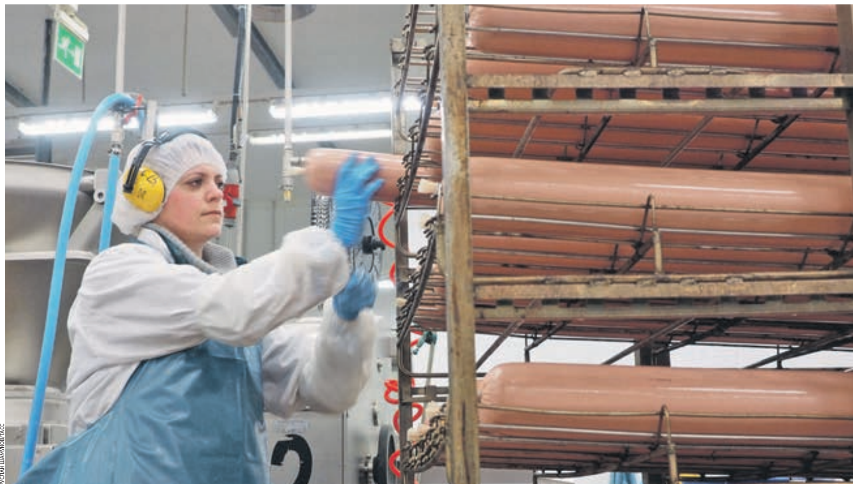
27 февраля 2017 года. В цехе по производству вареной колбасы. После варки в паровой камере — от 10 минут до 3 часов в зависимости от сорта колбаса охлаждается водой, и затем она уже готова к отправке в магазины
