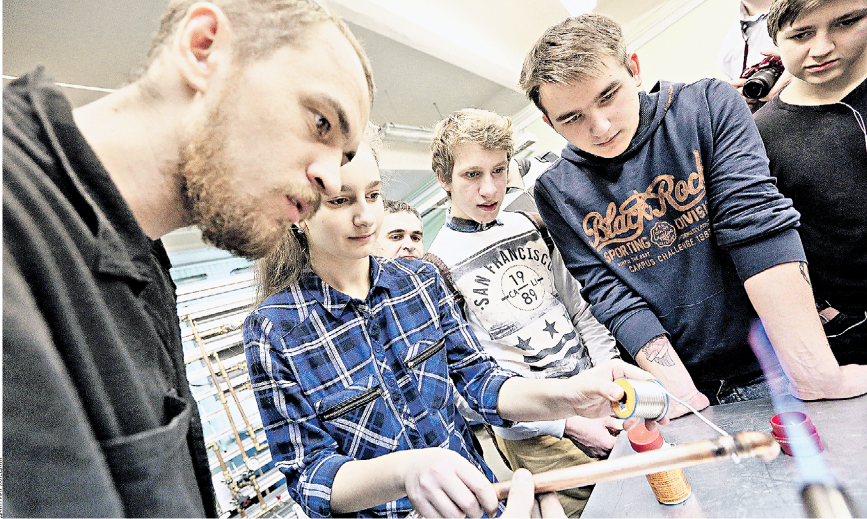
31 января 2015 года. Школьники учатся соединять медные трубы без паяльной лампы в образовательном учреждении «Колледж архитектуры, дизайна и реинжиниринга № 26»
