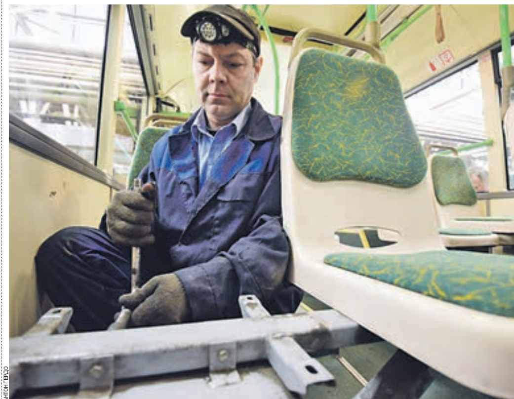
Вчера 13:45 Слесарь 6-го автобусного парка Роман Мищенко в салоне автобуса ЛиАЗ-5292 меняет отопительное оборудование
