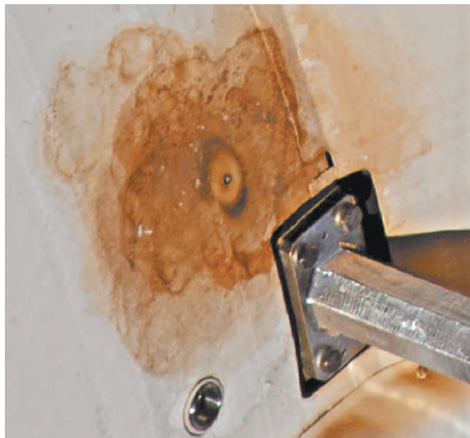
На снимке: нарушение внешней обшивки корабля «Союз МС-22».
