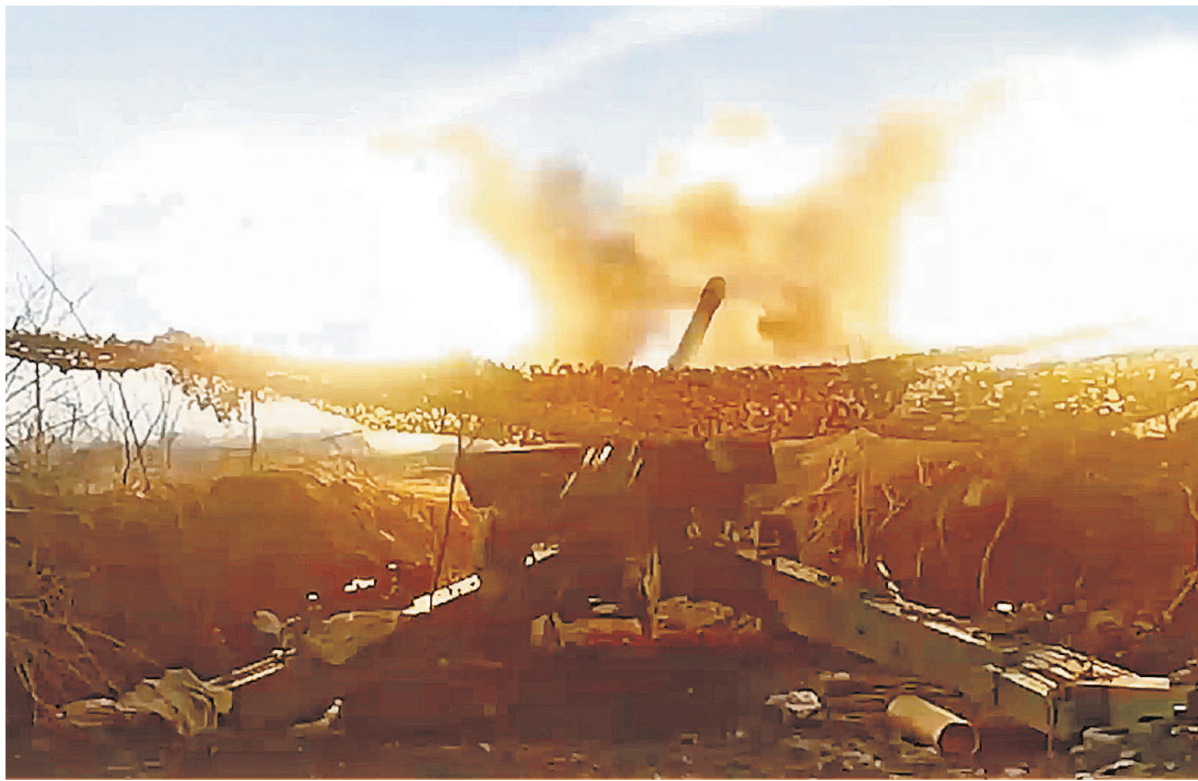
В ходе специальной военной операции расчеты буксируемых гаубиц «Гиацинт-Б» применяют для уничтожения бетонных укрытий противника 152-мм фугасные снаряды.
