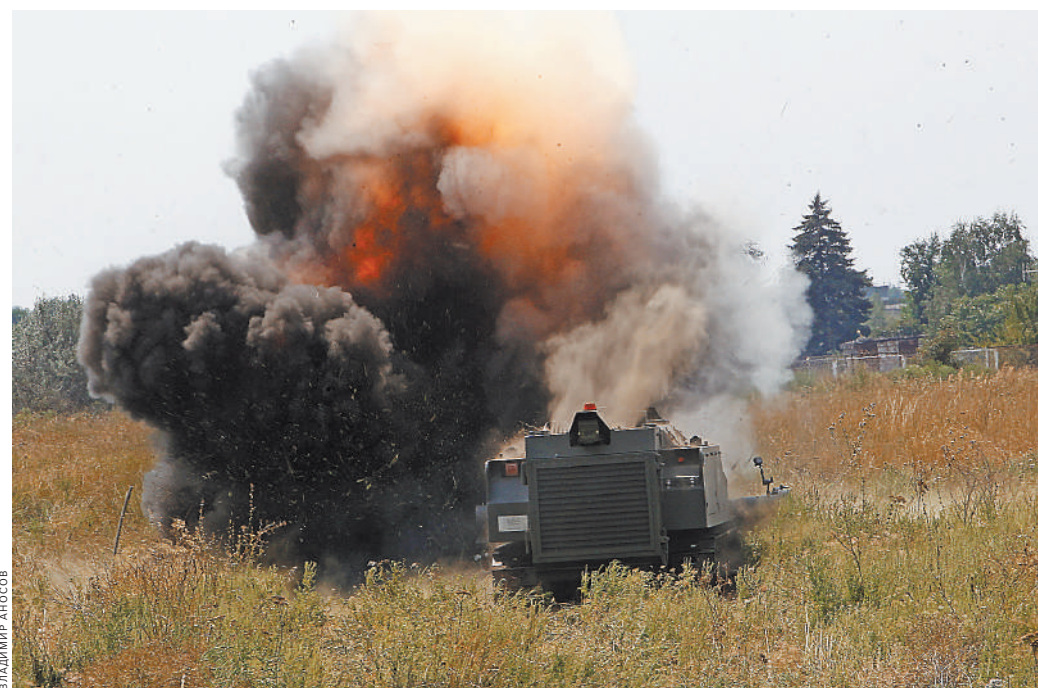
Робот-сапер «Уран-6» используют для очистки от мин на открытых участках местности.
