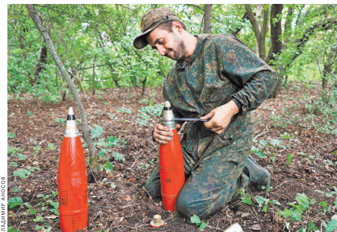
На агитснарядах взрыватель установлен так, чтобы они взрывались в воздухе. Тогда полторы тысячи листовок разлетятся на большое расстояние.
