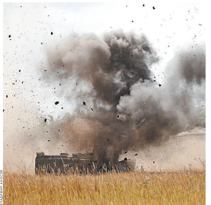
Робот-сапер уничтожает мины и прочие взрывоопасные предметы с помощью особого трала.
