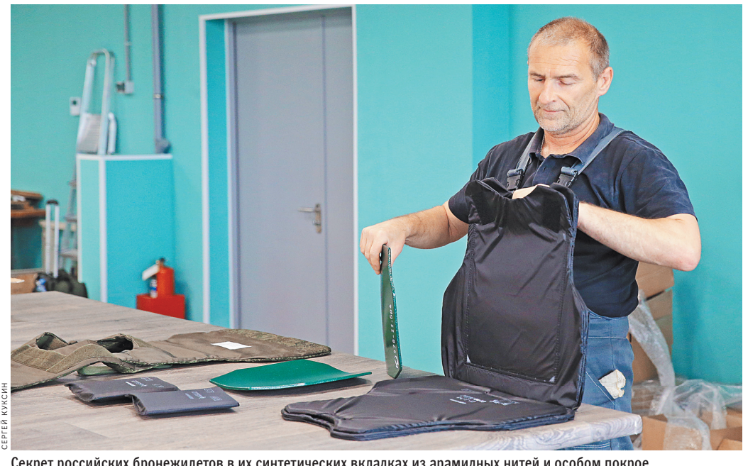
Секрет российских бронезилов в их синтетических вкладках из арамидных нитей и особом покрытии.
