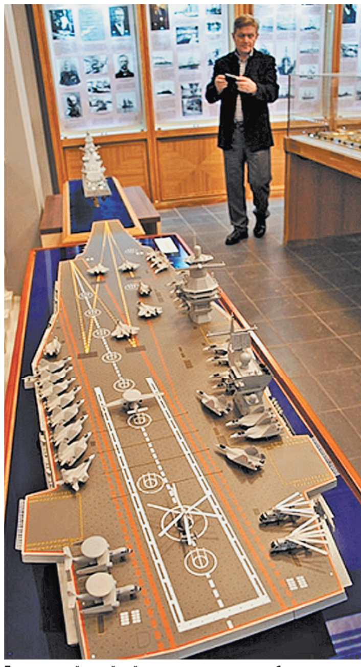
Перспективный российский авианосец сможет нести на борту все типы палубных летательных аппаратов — пилотируемых и беспилотных в количестве 90 машин. Он будет иметь надежную систему противоракетной и противокорабельной защиты. Экипаж плавучего аэродрома — 5000 человек.
