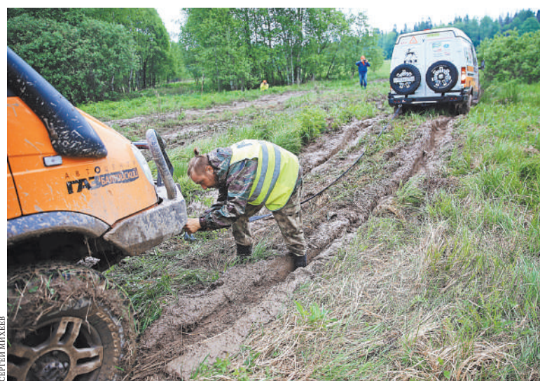
Обе подвески «Соболей» зависимые, это дает преимущества на бездорожье, а особого комфорта от этих машин, как правило, и не ждут.
