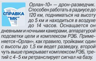
Орлан-10 — дрон-разведчик. Способен работать в радиусе до 120 км, поднимается на высоту до 5 км и находится в воздухе до 14 часов. Оснащается он дневными и ночными камерами, аппаратурой подсветки цели и комплексом РЭБ. Применяется «Орлан», как правило, тройками: один с высоты до 1,5 км ведет разведку, второй чуть выше прикрывает комплексом РЭБ, третий с 4–5 км ретранслирует сигнал на базу.
