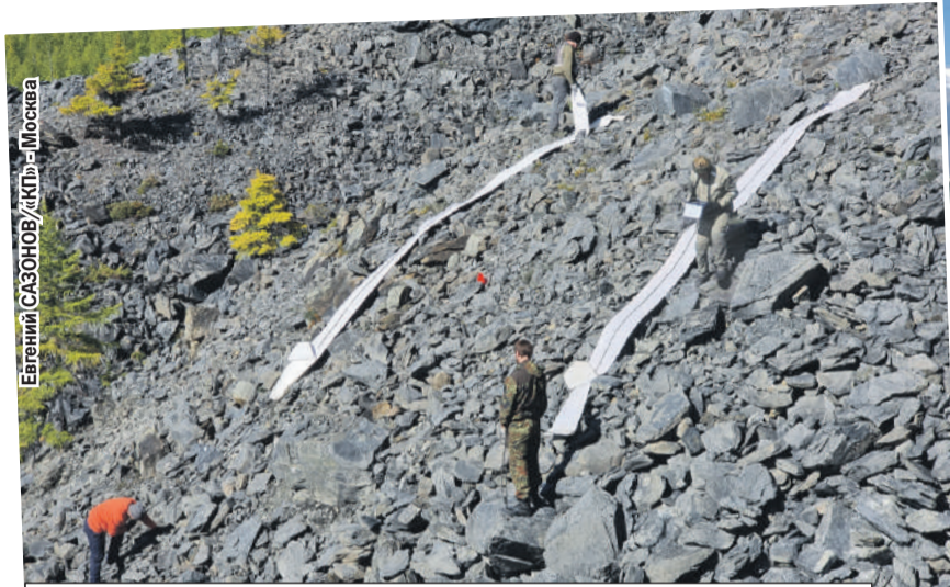
Со стороны георадар выглядит как две длинные ленты. Их протаскивают параллельно по склону и через каждые полметра производят измерения.
