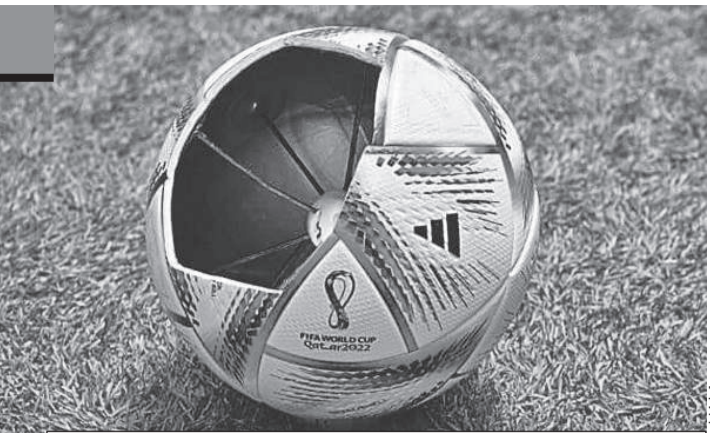
В центре сферы расположен датчик, который показывает не только положение мяча на поле, но и силу удара по нему.
