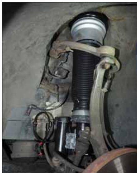
Фото 2: Новая деталь. Установлена правильно и будет функционировать адекватно. Пневмомодуль при этом опирается на втулку.
