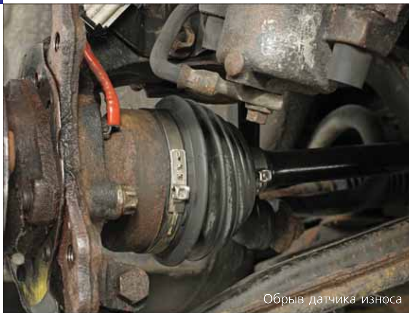
Нарушение целостности уплотнителей неизбежно приведет к появлению коррозии...
