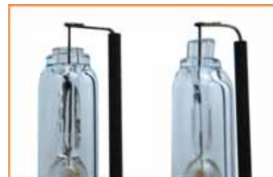
На фото: слева — заводская лампа OSRAM, справа — подделка
