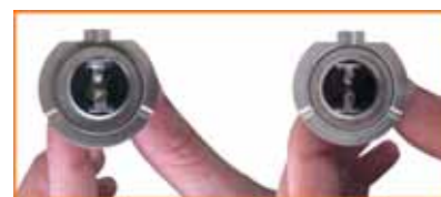
На фото: слева — маркировка цоколя контрафактной лампы, справа — оригинал OSRAM
