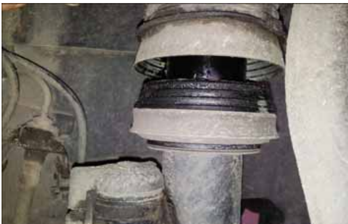
Фото 1: Пневмопружина отделилась от опорной резиновой втулки.
