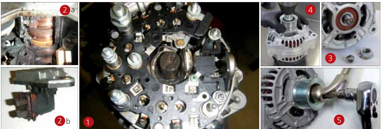
Рисунок 1: Остатки масла в генераторе. Рисунок 2: Повышенный износ коллектора (а). Повышенный износ щеток (b). Рисунок 3: Сорванная резьба. Рисунок 4: Ударные гайковерты разрешается использовать только для раскручивания гайки ременного шкива, но НЕ для закручивания! Рисунок 5: Ременной шкив всегда следует затягивать со стопором и с использованием динамометрического ключа.
