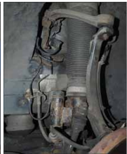
Фото 3: Старая деталь, но по-прежнему герметичная. Все же тут речь идет об очень старом пневмомодуле, и его ресурс можно поставить под сомнение. В этой ситуации рекомендуется протестировать подвеску.
