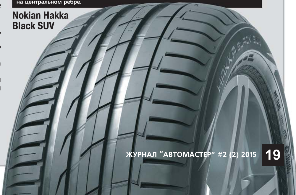
Канавки прорезаны по центральному ребрам от внутреннего «плеча» к внешнему.
